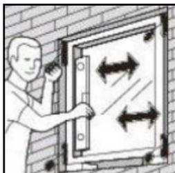
**3.** Com o auxílio de um nível de bolha verifique a posição e alinhe a janela;
